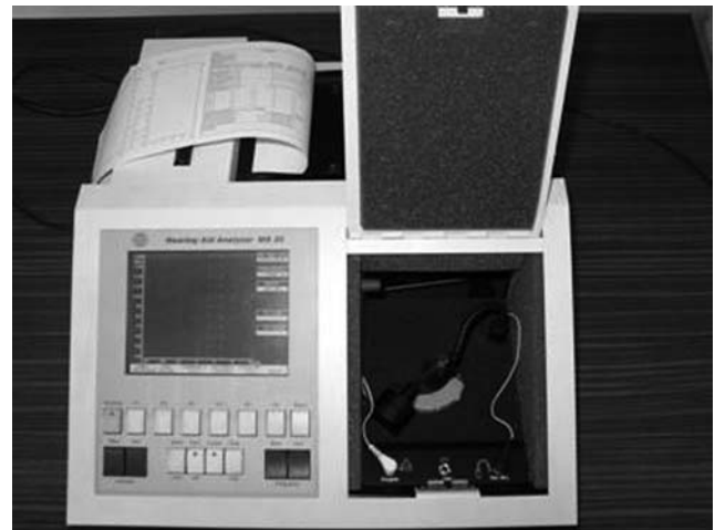
Şekil 1— MS 25 İşitme Cihazı Analiz Enstrümanı (test kutusunda işitme cihazı değerlendirilirken)
